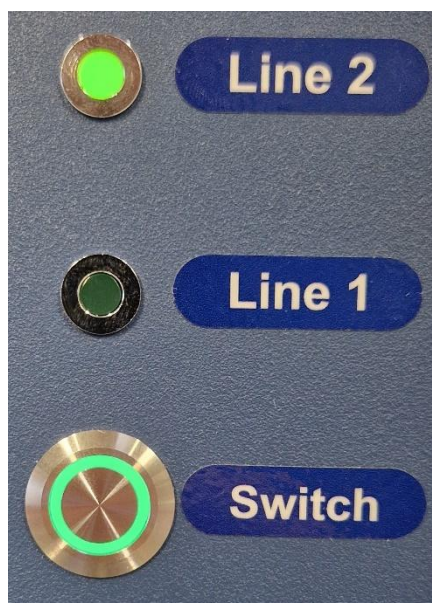
Εικόνα 20.4 Διακόπτης αλλαγής γραμμής του επωαστήρα εξωσωματικής γονιμοποίησης πολλαπλών θαλάμων MIRI® TL12 και ενεργή γραμμή 1
