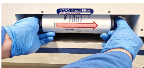
Εικόνα 12.2 Διαδικασία εισαγωγής και αφαίρεσης φίλτρου VOC/HEPA
