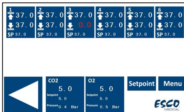
Εικόνα 14.4 Δυσλειτουργία αισθητήρα θερμοκρασίας στην αρχική οθόνη των επωαστήρων εξωσωματικής γονιμοποίησης πολλαπλών θαλάμων MIRI® TL6
