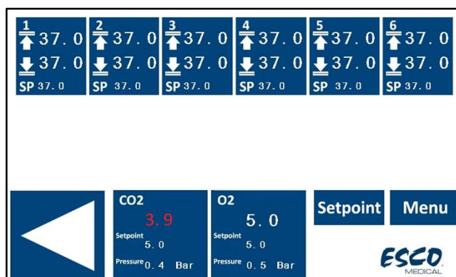
Εικόνα 14.5 Συναγερμός χαμηλής συγκέντρωσης CO 2 στην αρχική οθόνη του επωαστήρα εξωσωματικής γονιμοποίησης πολλαπλών θαλάμων MIRI® TL6
