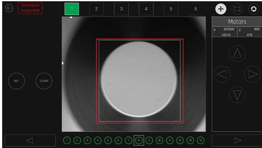
Εικόνα 20.41 Θέση φρεατίου μέσα στο επισημασμένο τετράγωνο όριο
