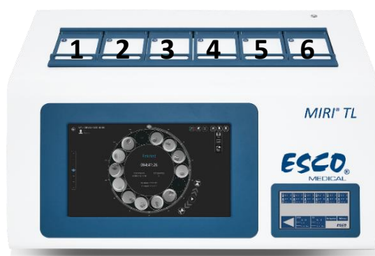
Εικόνα 7.1 Αριθμοί θαλάμων επάνω στον επωαστήρα εξωσωματικής γονιμοποίησης πολλαπλών θαλάμων MIRI® TL6
