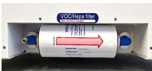
Εικόνα 12.3 Σωστά τοποθετημένο φίλτρο VOC/HEPA
